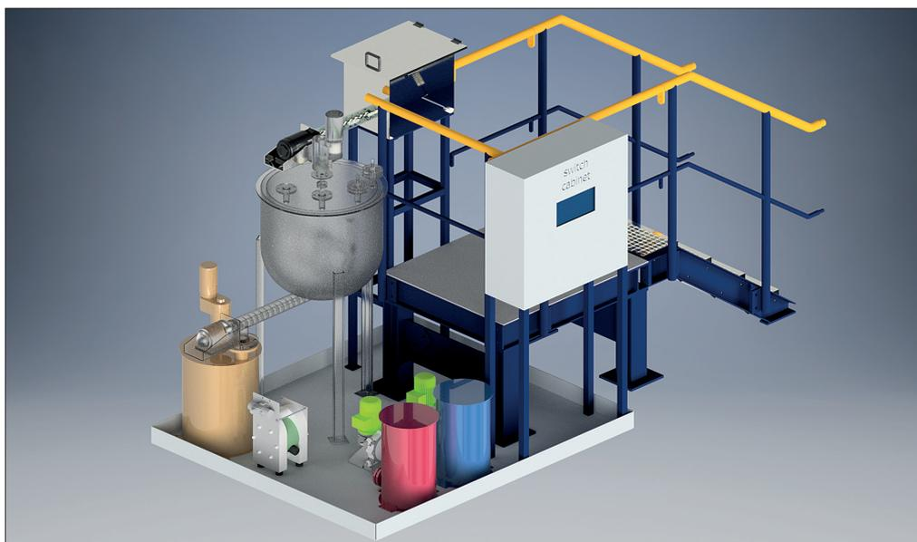
Abb. 1: Variante eines semi-automatischen Mauk-Reaktors
